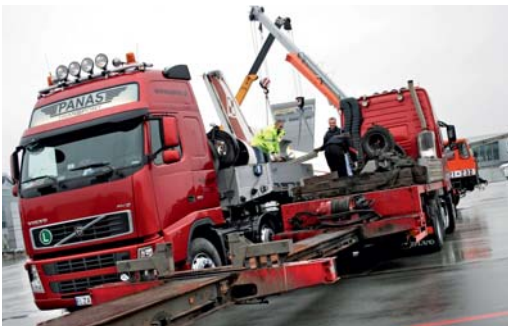
Przed załadunkiem należy przygotować sprzęt do zabezpieczenia ładunku oraz rozciągnąć naczepę na odpowiednią długość
