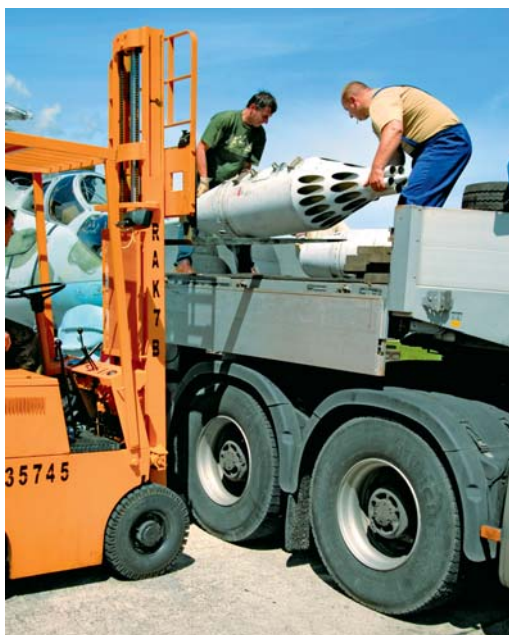
Zasobniki strzeleckie śmigłowca MI-24 są ładowane wózkiem widlowym na tzw. balkon naczepy
