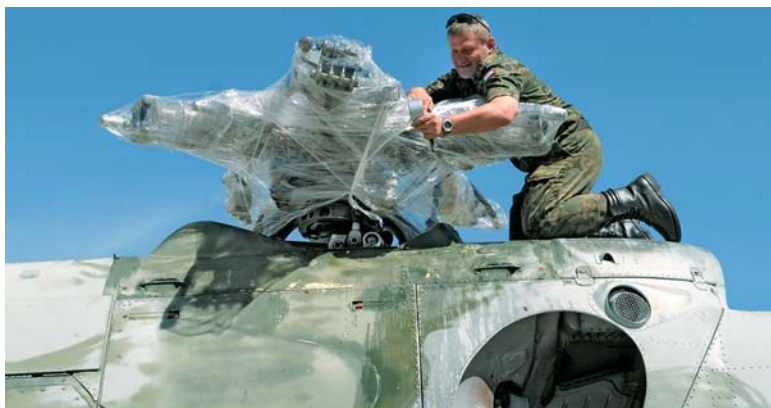
Wirnik śmigłowca musi na czas podróży zostać zabezpieczony folią. Śmigła MI-24 zostały wysłane do Łodzi wcześniejszym transportem
