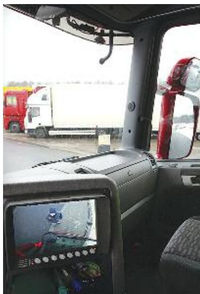
Kabina firmowej Scanii wyposażona jest m.in. w system monitoringu, który pokazuje tzw. martwe punkty i rejestruje to, co dzieje się w trakcie jazdy i postoju wokół pojazdu.
